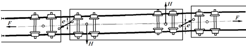
ნახ.№15. „მოთარეშე“ ურიკების წარმოქმნის სქემა კონსტრუქციული ექსცენტრისიტეტის e გამო.
