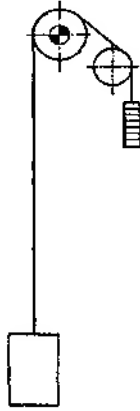
ნახ. 10.2. ბაგირული სისტემის სქემა ბაგირის ერთი შემოხვევით და ჯალამბრის ზემოთ განთავსებით ( i=1 )
