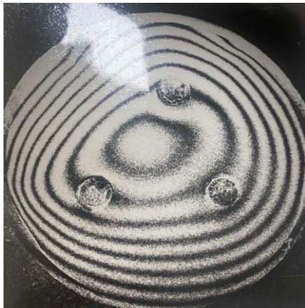
სურათი N12 გრანიტის შემვსევი ხისტად ჩამაგრებული ცემენტის მატრიცაში ასაკი 16 სთ
