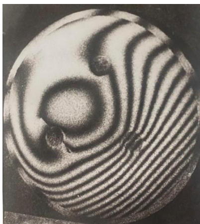
სურათი N12 გრანიტის შემვსევი ხისტად ჩამაგრებული ცემენტის მატრიცაში ასაკი 16 სთ
