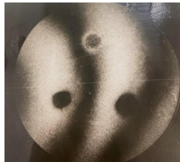
სურათი N7 ნიმუშის ასაკი 10 სთ გრანიტის შემვსებები ჩაწყობილია მატრიცაში თავისუფალ მდგომარეობაში
