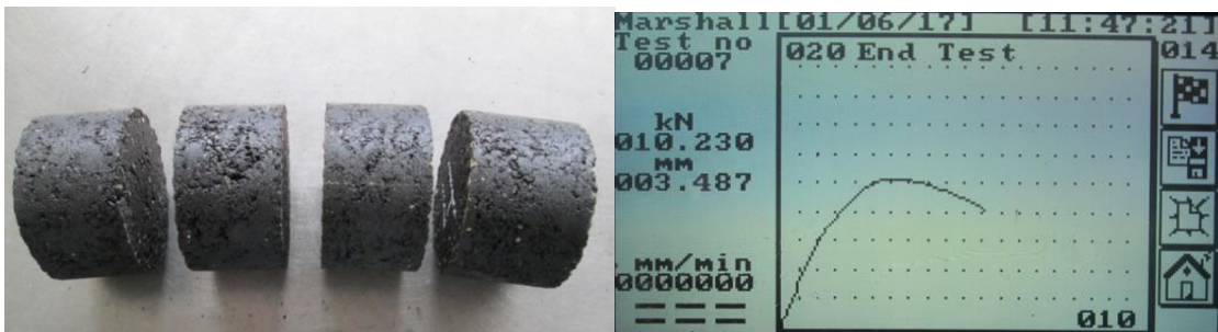
ნახ.7 უდანამატო ასფალტბეტონის მარშალის ნიმუშების გამოცდა მარშალის ტესტის ხელსაწყოზე - სტაბილურობასა და დენადობაზე.
