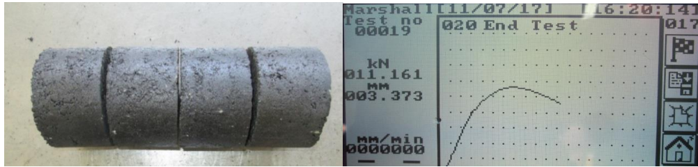
ნახ. 9. 20% მოდიფიცირებული გოგირდით დამზადებული გოგირდასფალტბეტონის მარშალის ნიმუშების გამოცდა სტაბილურობასა და დენადობაზე
