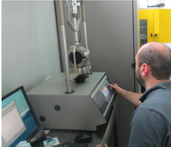
ნახ. 6. უდანამატო ასფალტბეტონის მოდიფიცირებული გოგირდის 10%, 20%, 30% დანამატით დამზადებული გოგირდასფალტბეტონის მარშალის ნიმუშების გამოცდის პროცესი მარშალის ტესტის ხელსაწყოზე
