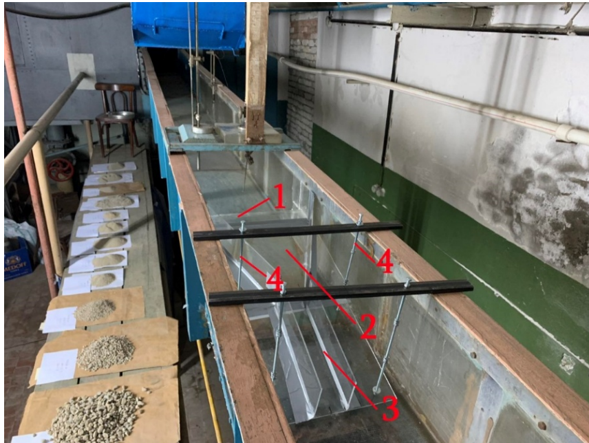
სურ. 1 ფართოზღურბლიანი წყალსაშვის წყალსაგდებ ნაგებობასთან შეუღლების ჰიდრაულიკური მოდელი
