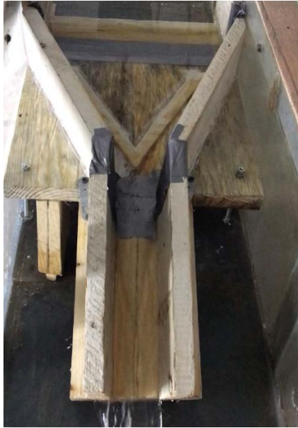
სურ. 3 არაპრიზმული მოდელის ბოლო ვარიანტი სწრაფდენთან შემაუღლებელი ღარქიმიანი ნაგებობის მოდელი
