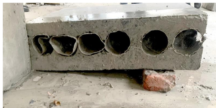
სურ. 64. GEO Ket ბოთლებიანი ბეტონის ფილის ჭრილი
